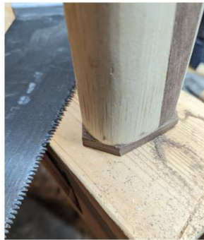
Überstände grob mit der Säge geschnitten und mit 80er Schleifpapier abgerundet.
