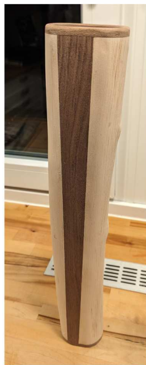
Von Hand mit 80er, 120er und 180er Schleifpapier geschliffen. Dann feucht gemacht, damit sich die Fasern aufstellen.
