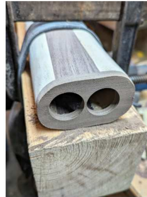
Oben mit einem Forstnerbohrer zwei Löcher rein.
