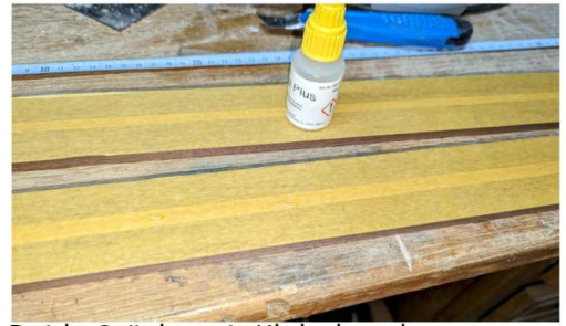
Beide Stücke mit Klebeband abgeklebt, ein paar Tropfen Sekundenkleber aufgetragen und aufeinander geklebt.
