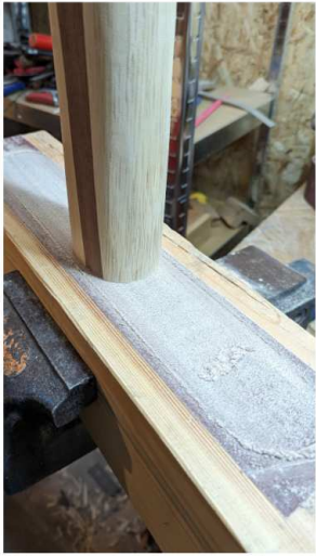
Oben und unten plan geschliffen.
