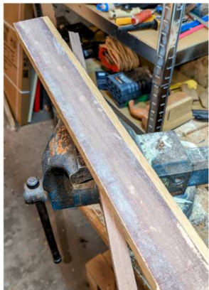
Da ich nicht in der Lage bin mit einem Hobel vernünftig abzurichten, hab ich den Rest mit 80er Schleifpapier, das auf einem planes Stück Holz geklebt wurde, gemacht.
