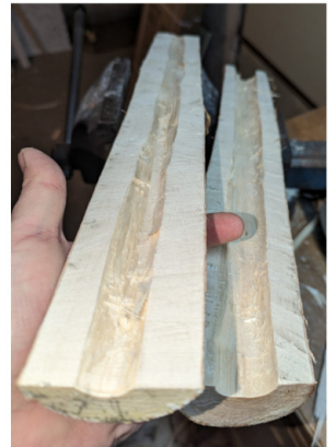
Mit einem Hohlbeitel schon mal etwas rausgearbeitet
