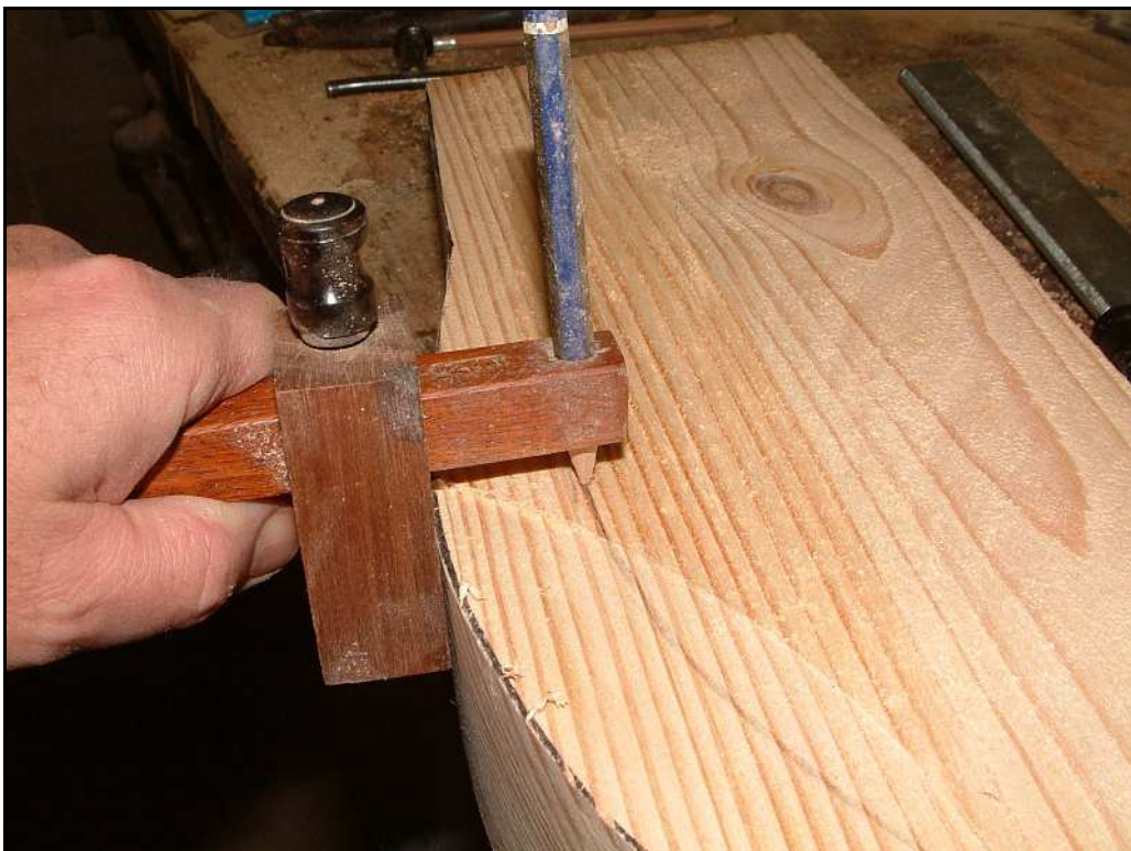
Abb. 4: Mit einem Streichmaß wird die Linie „gedoppelt“.
