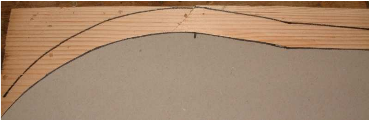
Abb. 3: Über eine Schablone wird die Kurvenlinie auf eine Bohle übertragen
