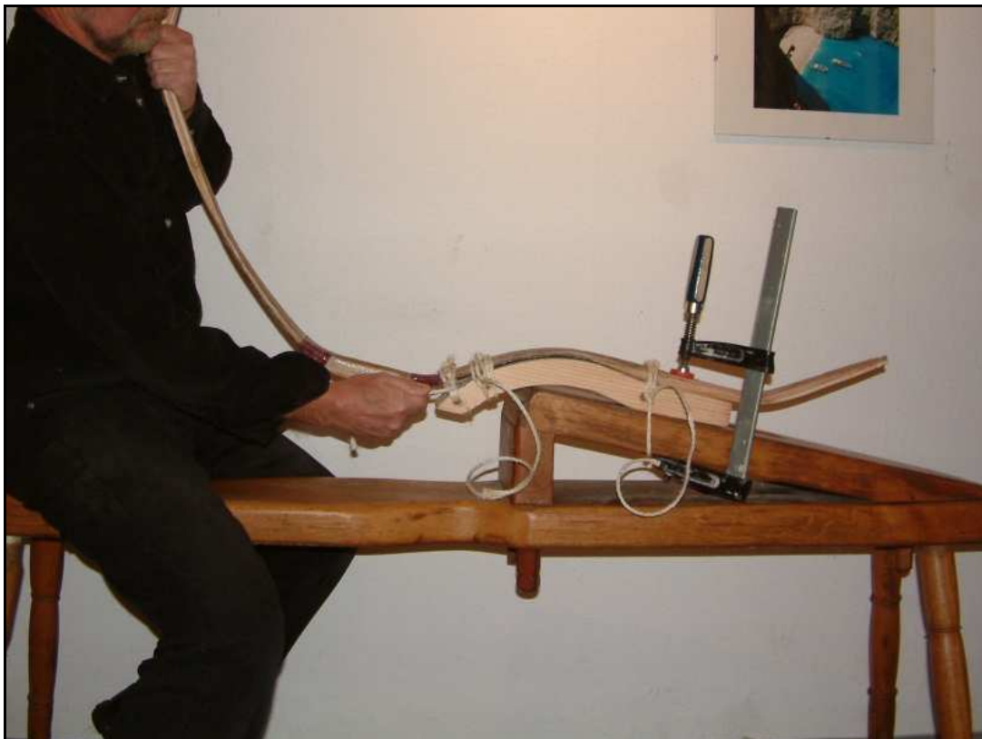
Abb. 8: Ein Wurfarm wird fixiert und mit dem anderen als Hebel biegt man ihn um den Tepelik und fixiert mit den Schnüren
