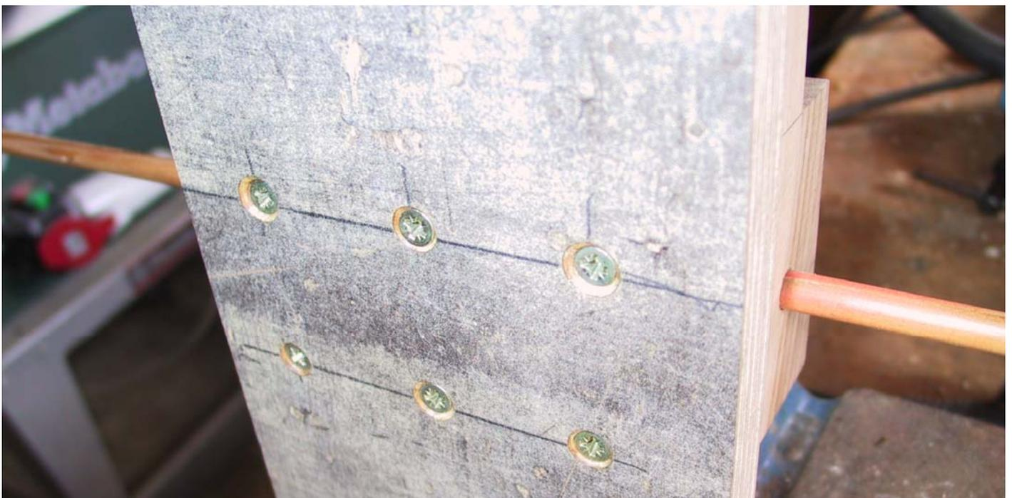
Jetzt wird der 30x30x110mm Querklötz für die Klingenhaltung angepaßt und gebohrt. Das erste Loch kann man irgendwo bohren. Erst nachdem man dieses erste Loch gebohrt hat und den Klotz mit der ersten Schraube gesichert hat, wird das zweite Loch gebohrt. Dadurch wird auch die zweite Bohrung deckungsgleich und paßgenau.
