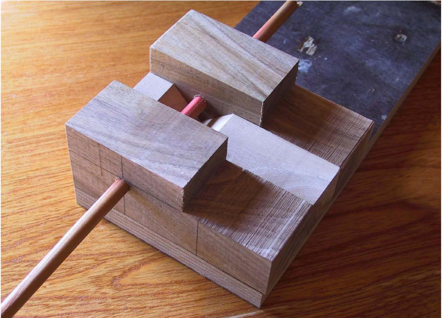
Jetzt kann man die drei Teile auf die Grundplatte schrauben. Es darf aber nur in den dickeren Bereichen geschraubt werden, da in den Ausklinkungen noch gebohrt werden muß. Damit die Löcher fluchten, wird ein Schaft durchgesteckt. Wie man die Anordnung ausrichtet (längst oder quer), hängt davon ab, wie man die Vorrichtung später einspannen will.
