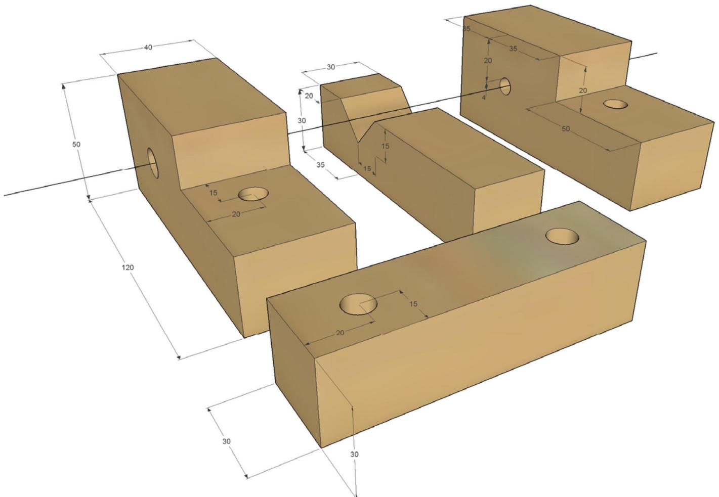
Zuerst werden die Holzstücke zu geschnitten und die 40x50x120mm großen Stücke erhalten eine Ausklinkung von 50x20mm.
