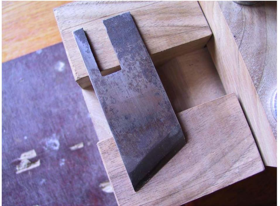
Nun kann alles zusammengebaut und justiert werden. Sollte das Messer zu tief oder zu hoch liegen, kann das mit ein paar Papier- bzw. Pappstückchen ausgeglichen werden. Jedenfalls soll das Messer fest auf dem Probeschaft aufliegen. Nach dem Probelauf muß man evtl. noch einmal nachjustieren.
