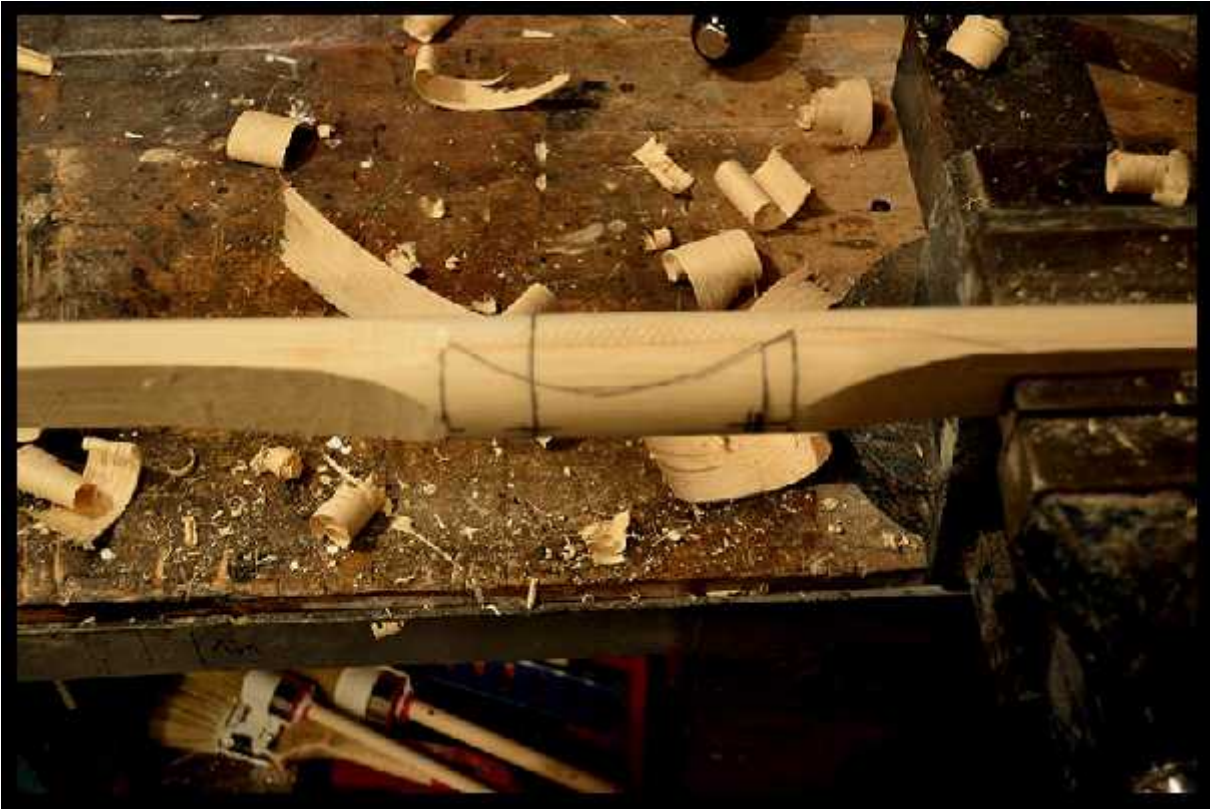
Das Griffstück mit ausgearbeiteten Fadeouts bis in die Wurfarme:
